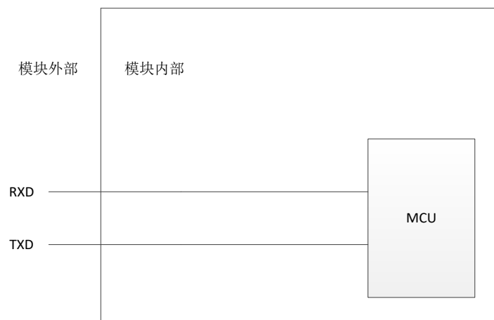
图 5-4 RXD、TXD 引脚内部结构示意图
