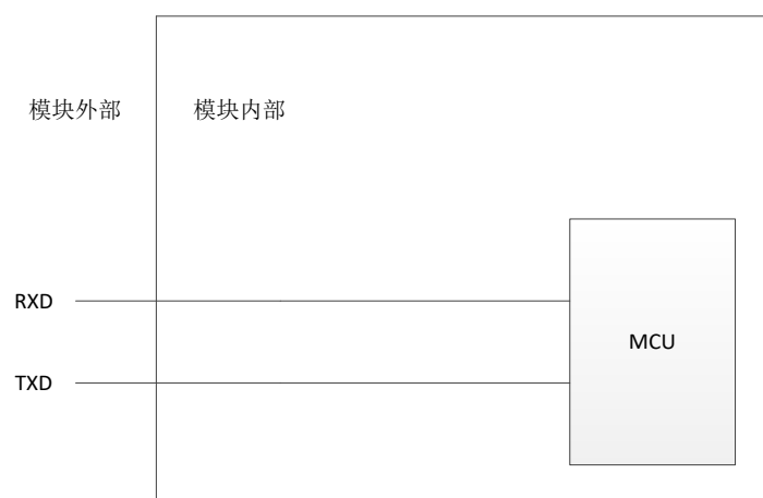
图 5-4 RXD、TXD 引脚内部结构示意图
