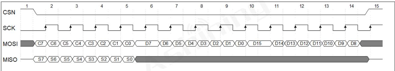
图 5-6 SPI 写操作时序图
