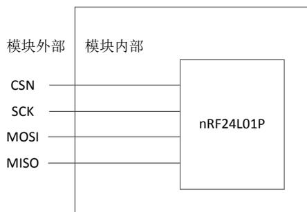
图 5-4 SPI 引脚局部连接示意图
