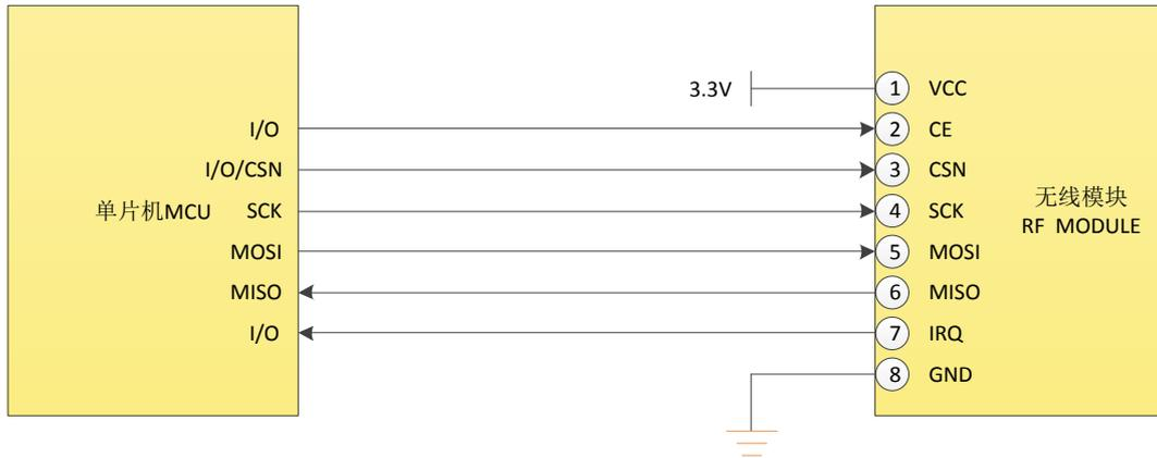
图 5-1 推荐连接图
