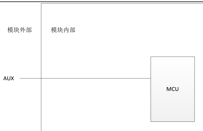
图 5-3 AUX 引脚内部结构示意图
