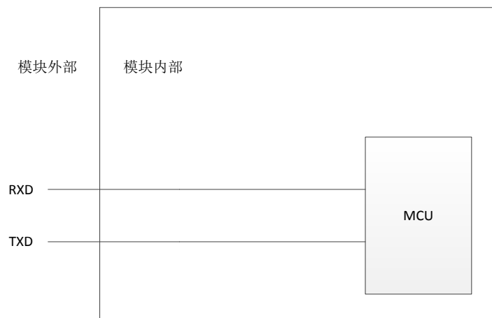
图 5-4 RXD、TXD 引脚内部结构示意图
