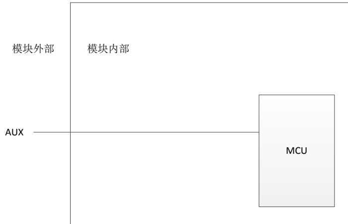
图 5-3 AUX 引脚内部结构示意图
