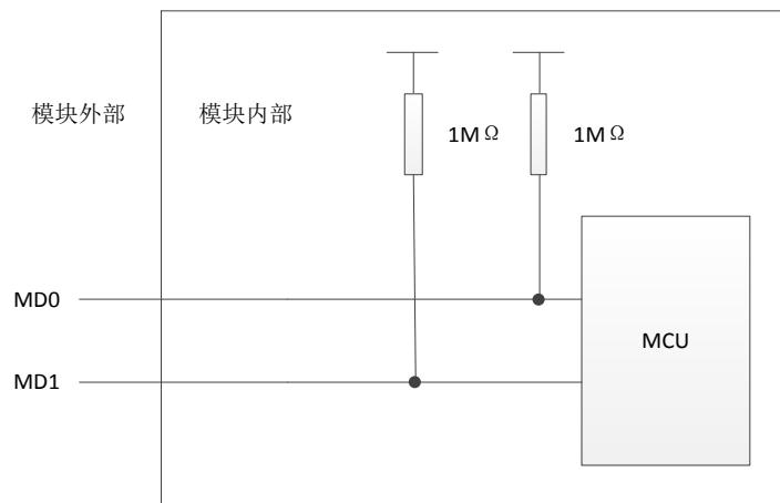
图 5-2 MD0、MD1 引脚内部结构示意图
