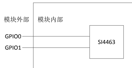
图 5-4 GPIO0、GPIO1 引脚局部连接示意图
